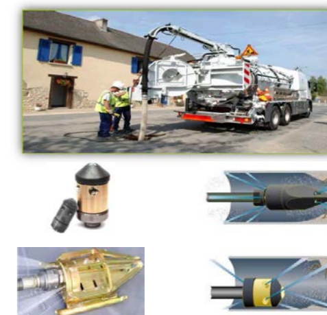
illustration - Technique de curage de réseau EU
