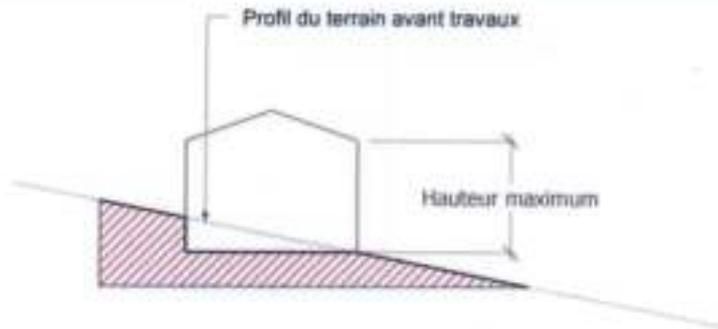
Cas d'une construction dont le pied de façade correspond au terrain avant travaux
